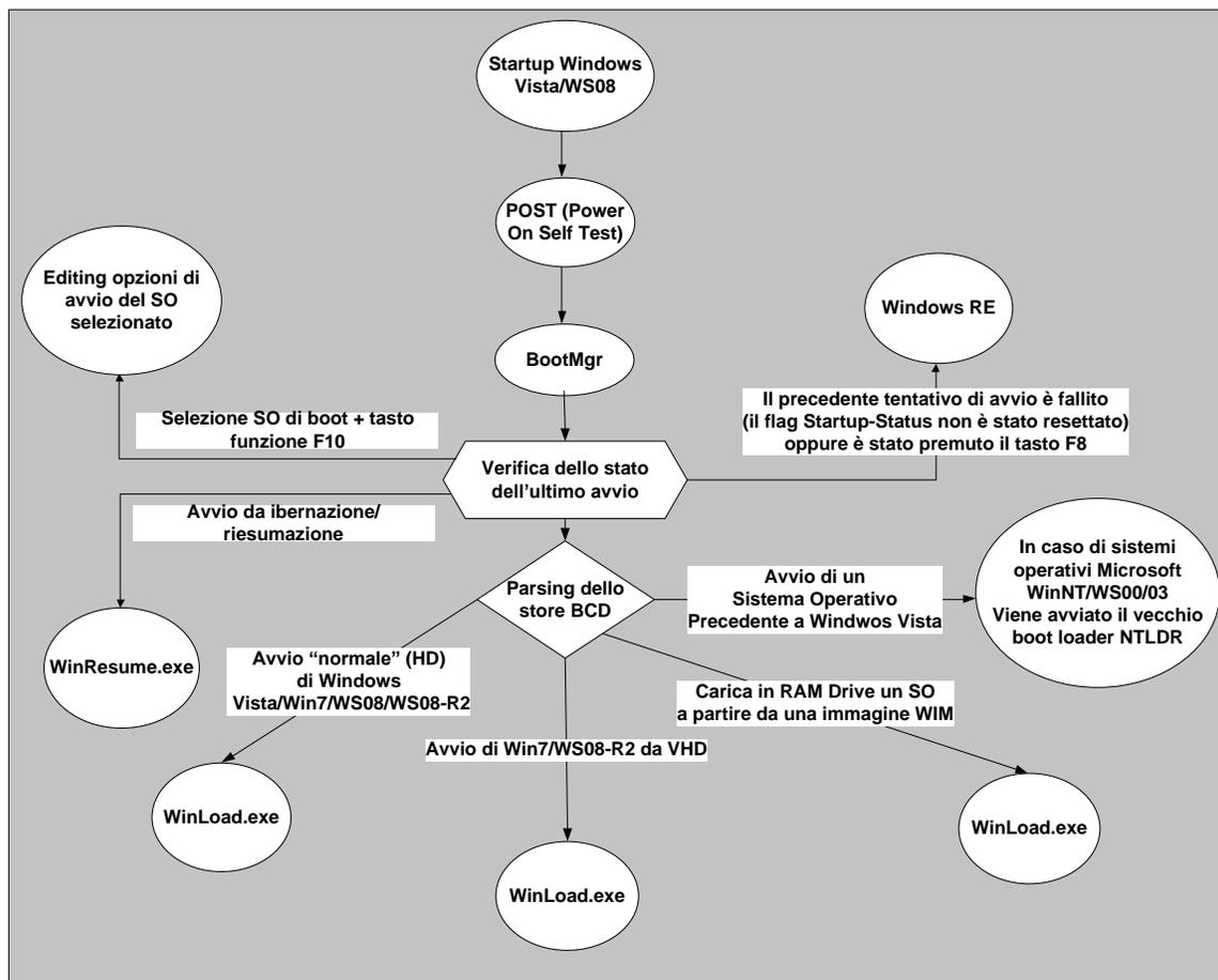
Figura 2: Diagramma di flusso dell'avvio di un sistema operativo a partire da Windows Vista
