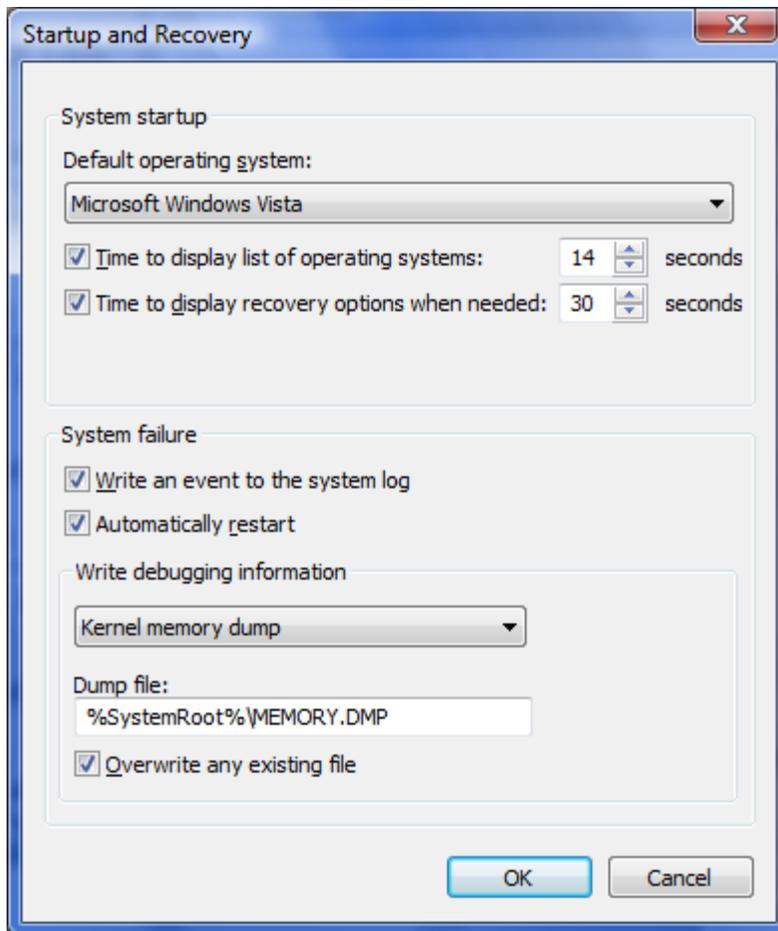
Figura 8: Configurare le opzioni di Startup e Recovery tramite pannello di controllo (sysdm.cpl)
