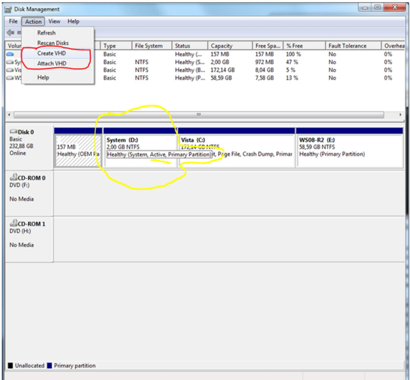
Figura 17: Creazione e Mount di un disco tramite la console Disk Management
