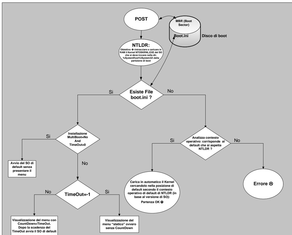
Figura 1: Diagramma di flusso dell'avvio di un sistema operativo precedente a Windows Vista
